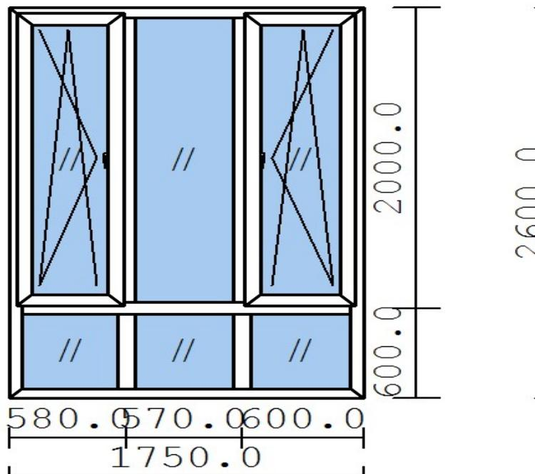
Парапет испуна полиуретаном-двоструко са изолацијом
